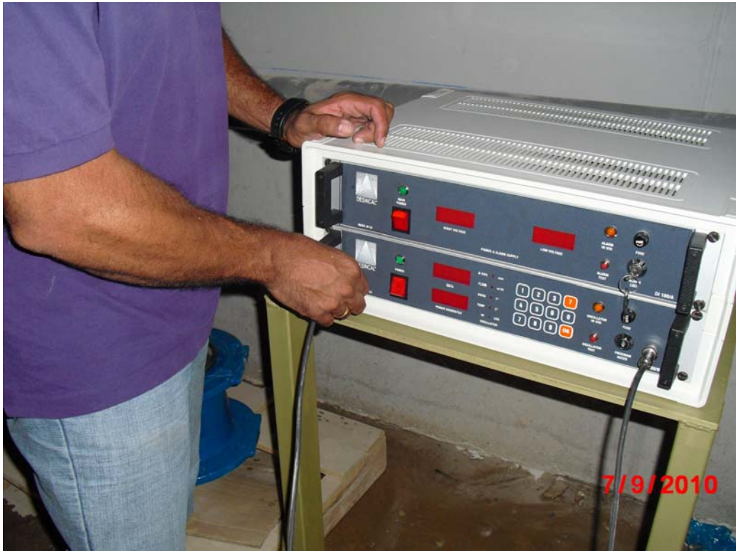
Conexión entre el dispositivo y los electrodos de transferencia capacitiva
